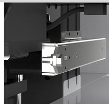
A cabeça da máquina é equipada com um sensor infravermelho anti-colisão, o caminhão de tinta para automaticamente quando tocado, e proteção multifacetada da cabeça de impressão.
